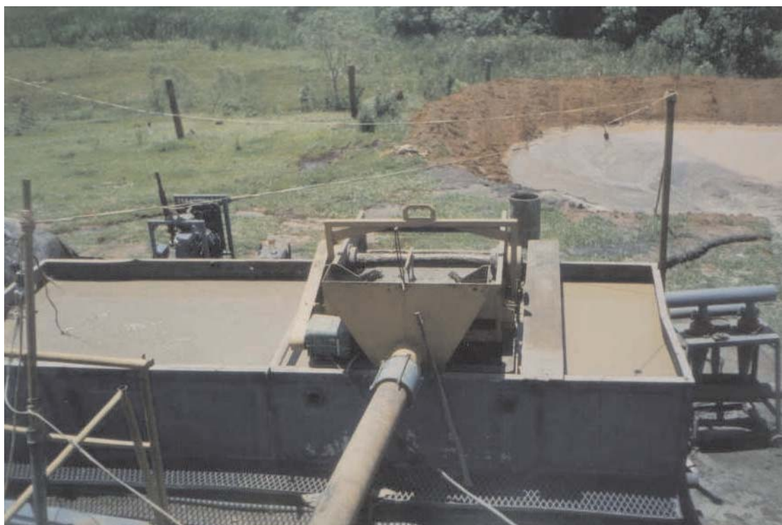
Figura 9.- Tanque de lama – peneira vibratória. Parte de um canteiro de obra – mostrando tanque de lama, com peneira vibratória.
