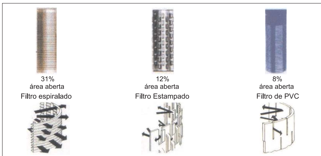
Figura 16.- Tipos de filtro e esquema de fluxo neles
