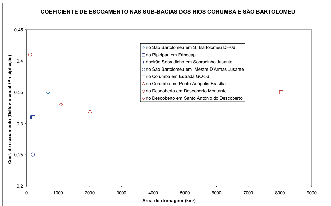
Figura 10.17 – Coeficiente de escoamento x área de drenagem.
