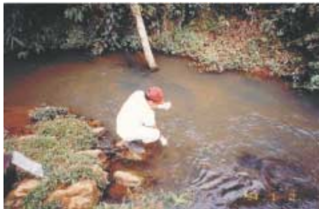
Foto 9.6 – Utilização de luvas cirúrgicas na coleta de água no ribeirão Sobradinho, procurando-se minimizar a possibilidade de contaminação.
