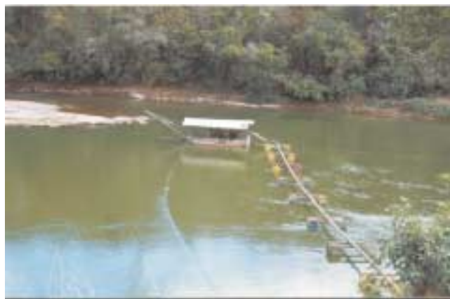
Foto 4.1 – Draga de extração de areia aluvionar do leito do rio Corumbá.
