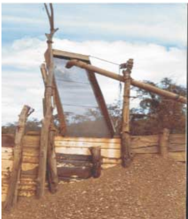
Foto 4.2 – Detalhe da peneira de separação de areia e seixos.
