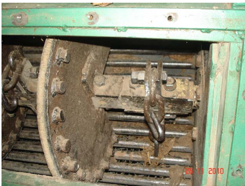
FOTO 6 – Detalhe da corrente e discos instalados no descascador desenvolvido pela Fundação Mussambê. - Comunid. de Itaquaritúia, Viana, Ma
