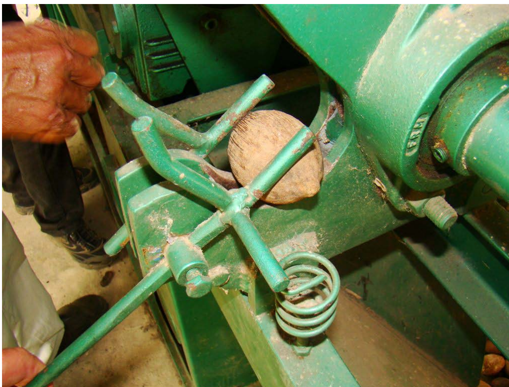
FOTO 11 – Sistema de fixação do coco no equipamento de corte desenvolvido pela Fundação Mussambê. - Comunidade de Itaqueritua, Viana, Ma
