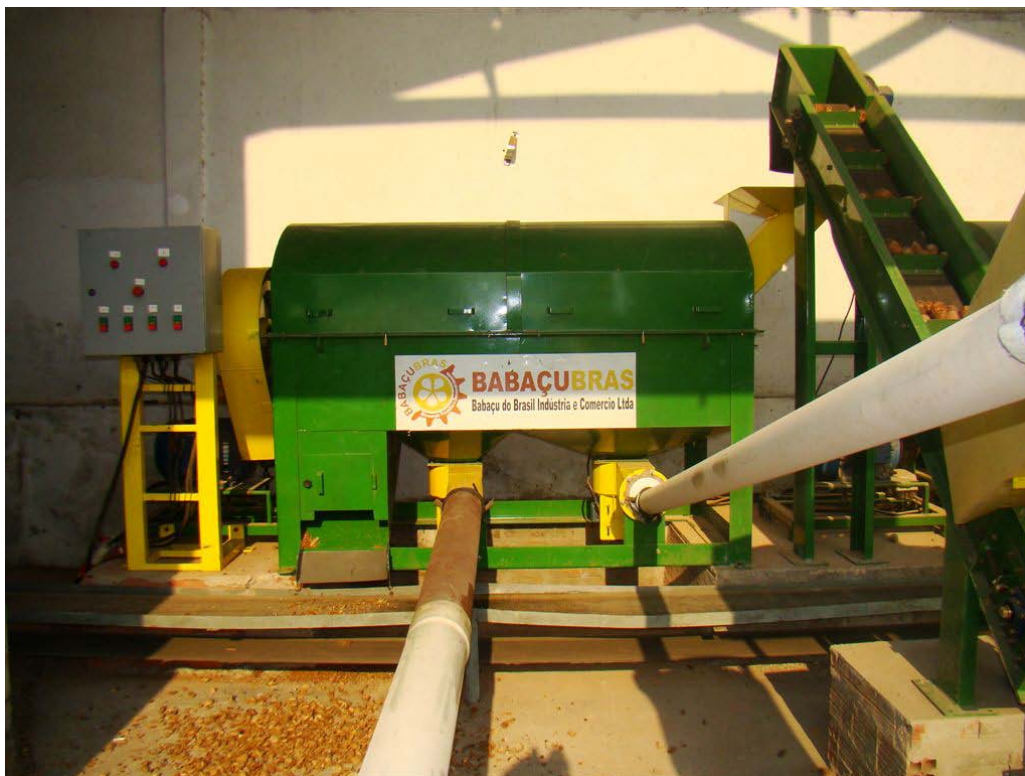
FOTO 3 – Máquina desenvolvida pela BABAÇUBRÁS – descasca e quebra o coco simultaneamente, instalado em Pirapemas, Ma.
