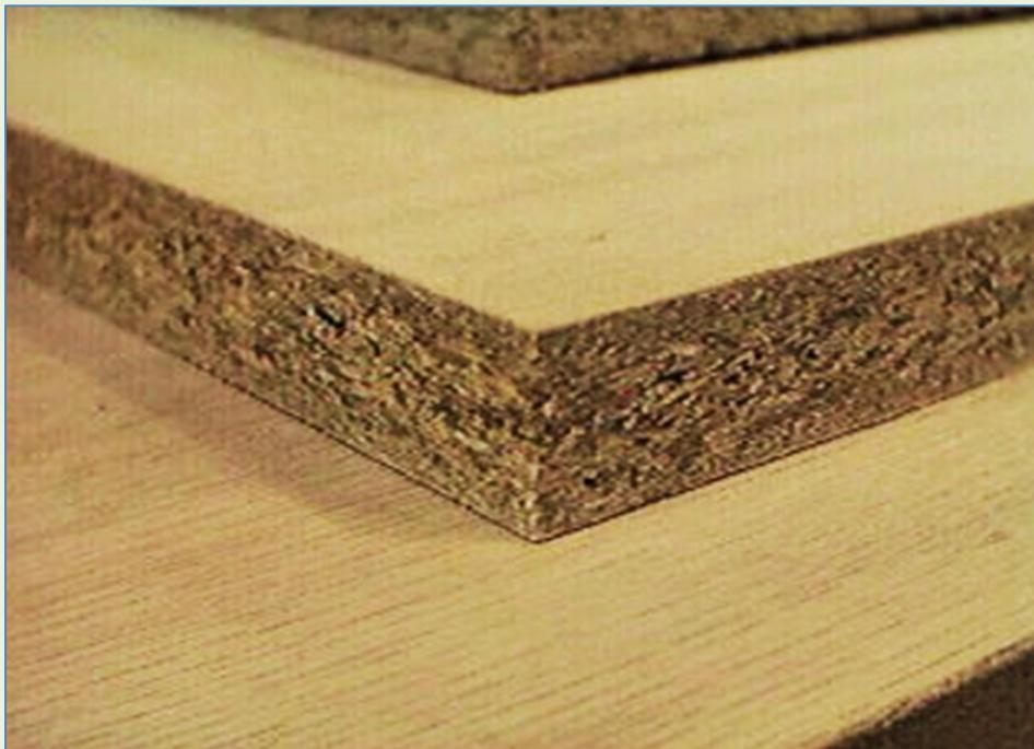
**MDP** → *Medium Density Particleboard* ou Partículas de Média densidade: é formado por três camadas de pedaços de madeira triturada, geralmente *pinus*, sendo as duas camadas externas mais finas e a interna mais grossa.
