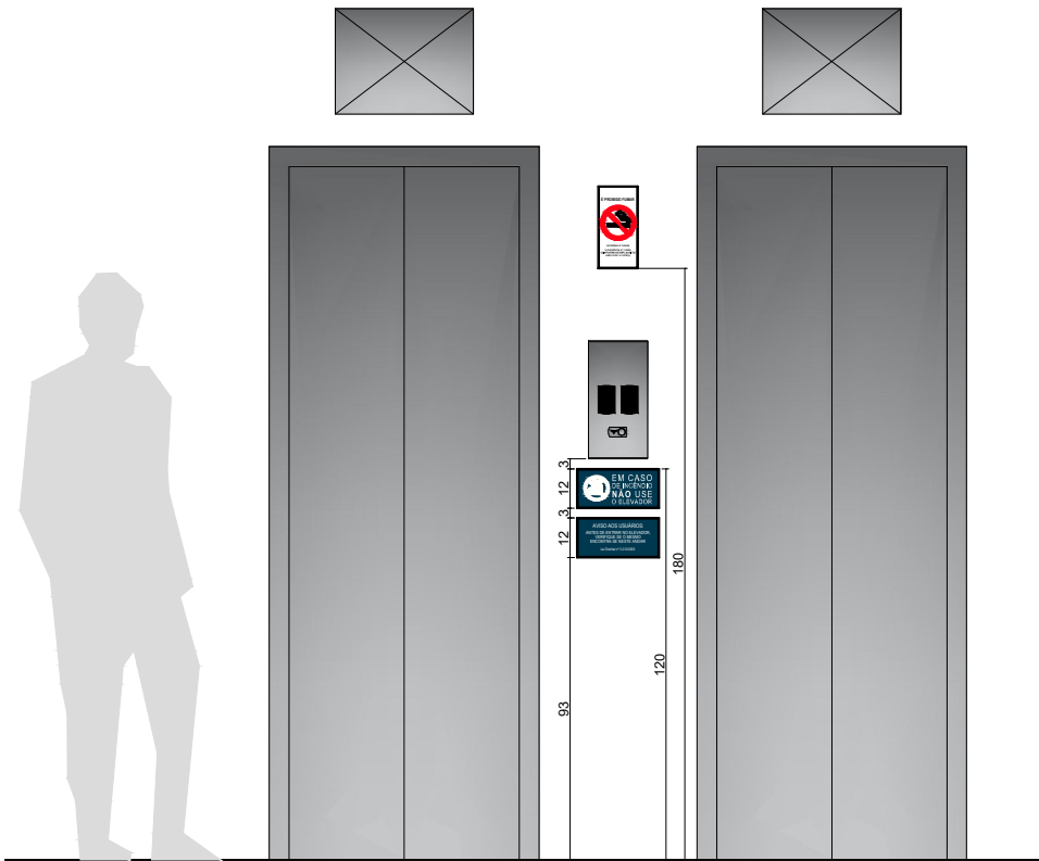
DET. INSTALAÇÃO DE PLACAS DE AVISOS DE CIRCULAÇÃO VERTICAL ESCALA 1:15
