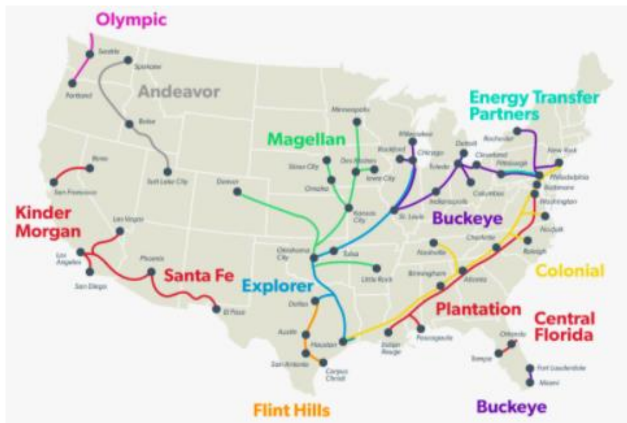
Figure 7. Principais oleodutos transportadores de combustíveis de aviação nos Estados Unidos
