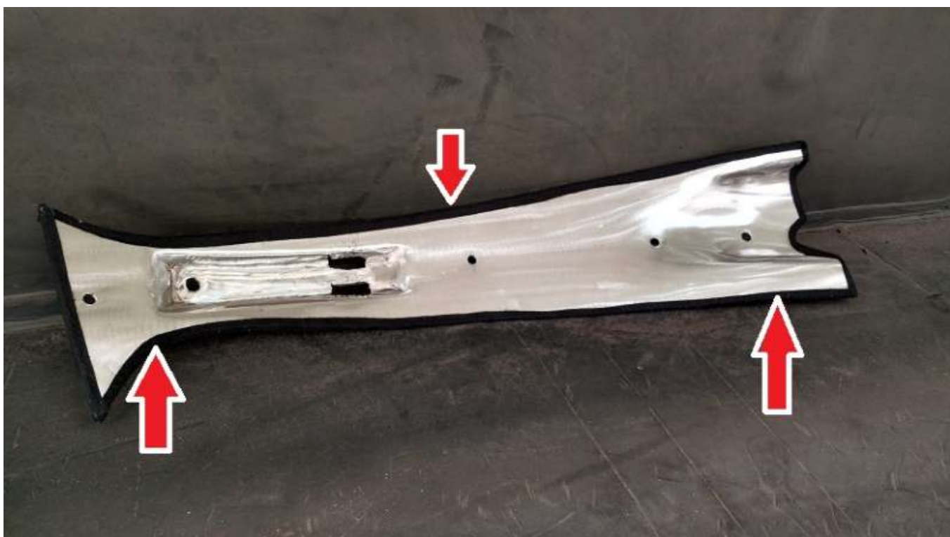
Figura 3 - Detalhe da aplicação da fita feltro nas bordas das chapas de aço
