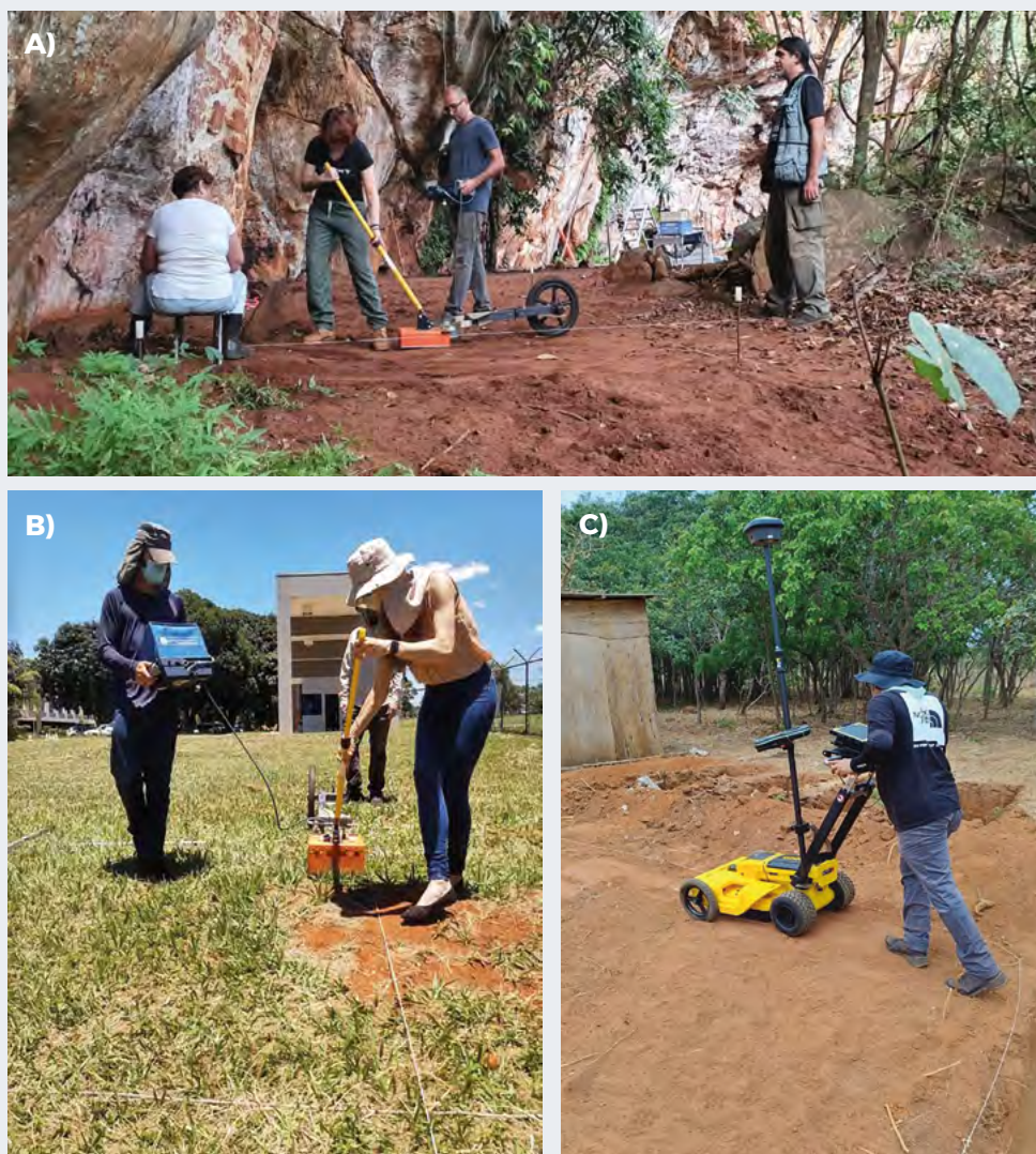
Figura 2. Aquisição de dados com GPR em diferentes cenários, forense e arqueológico: (A) Levantamento em sítio arqueológico GO-JA-02 em Serranópolis-GO; (B) Operação do GPR em área de campo teste da Polícia Federal em Brasília (SITCRIM), sem integração GNSS; (C) Levantamento no Centro de Estudos Tafonômicos (CET/PF) com GPR acoplado a receptor GNSS de alta precisão.
