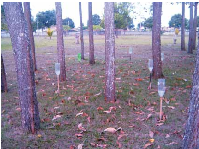
Figura 06. Pluviômetros confeccionados com garrafas PET para monitorar interceptação vegetal e precipitação interna em área da escola.
