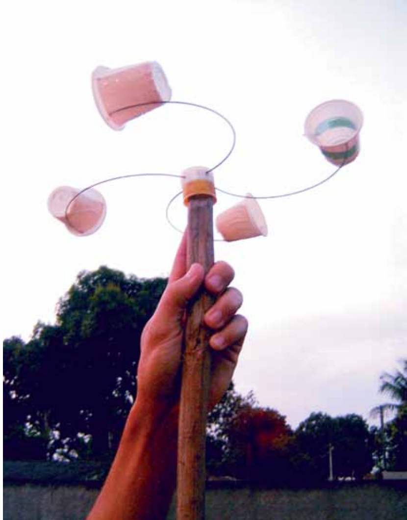
Figura 03. Anemômetro de canecas feito com copo descartável
