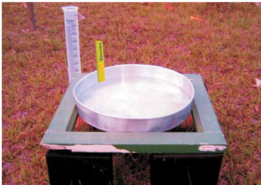
Figura 04. Evaporímetro feito com uma assadeira.
