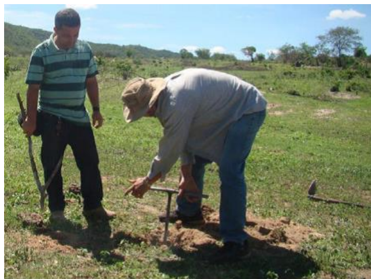
Figura 1: Sondagem do terreno
