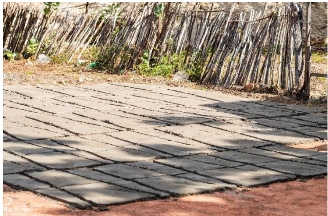
Figura 7: Processo de confecção e secagem das placas
