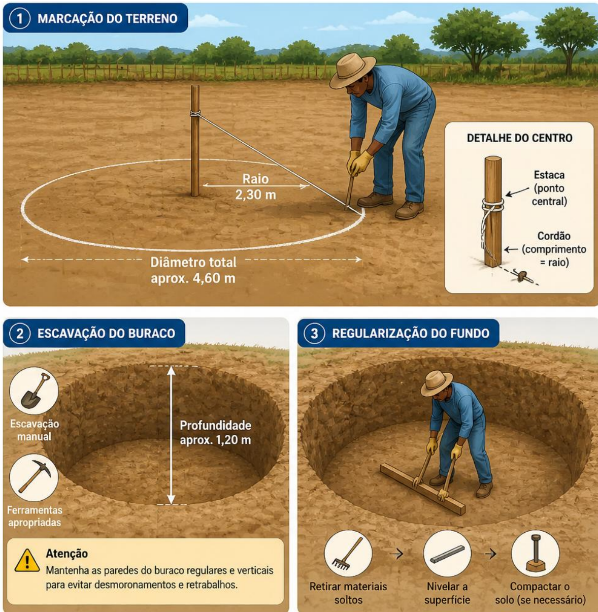
Figura 3: Marcação e escavação do buraco da cisterna
