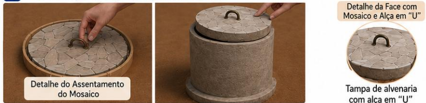
Figura 17: Componentes e montagem do modelo do dispositivo Cisterninha com tampa para proteção da qualidade da água
