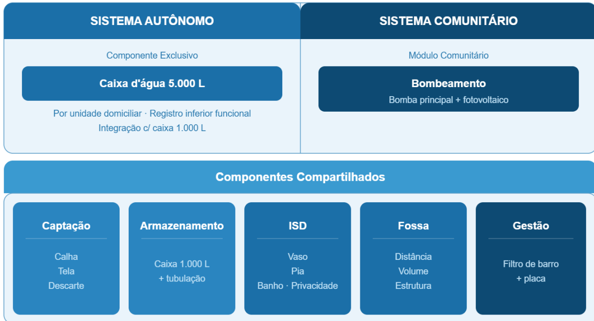
Figura 4: Sistemas Autônomo e Comunitário: componentes exclusivos e compartilhados entre os dois modelos
