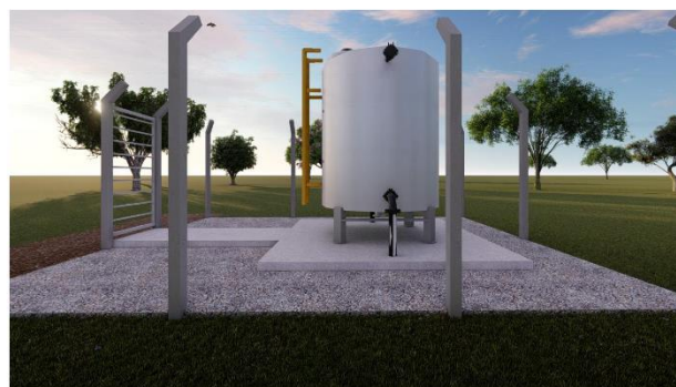
Figura 7: Desenhos do Booster e do Reservatório de Quebra de Pressão. Fonte: ARH Projetos e Consultoria Ltda.
