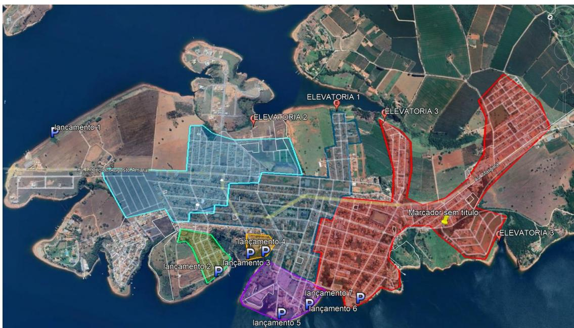
Os pontos identificados na imagem acima, são os de influência do sistema de esgoto de Guapé na atualidade, a imagem demonstra a península formada pelo lago de furnas, e a necessidade de tratamento do esgoto da cidade. Onde o lançamento causa vulnerabilidade hidrica tanto para consumo humano, quanto de uso com lazer, atividades econômicas e recreação.
