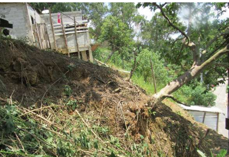
Figura 10. Árvores inclinadas, degrau de abatimento e material deslocado por deslizamentos. Fonte: LabGRis, 2020.
