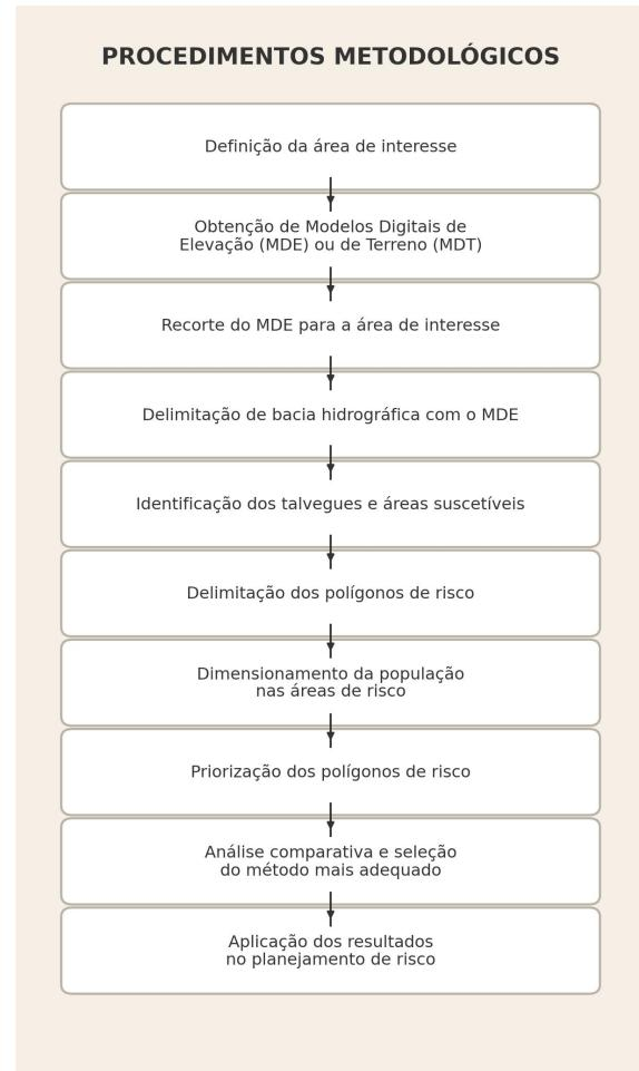
Figura 4: Procedimento metodológico para Priorização de Talvegues Suscetíveis a Fluxos de Detritos para Implantação de Barreiras SABO
