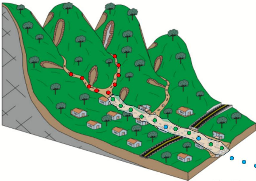
Figura 13: Delimitação das áreas de risco em função dos polígonos de declividade (Adaptada de CPRM, 2018)
