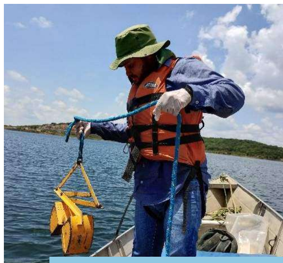
Coleta de sedimentos e zoobentos de fundo utilizando a draga de Petersen, na estação amostral Q17, Reservatório Cipó (Eixo Norte).
