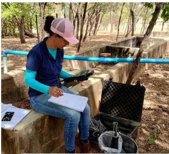
Obtenção de dados físico-químicos da água, utilizando a sonda multiparâmetros, ponto amostral P15B, município de Mauriti - CE (Eixo Norte).
