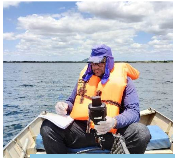
Utilização de sonda multiparâmetros para obtenção de dados físico-químicos, na estação amostral Q54, Reservatório Itaparica - Captação (Eixo Leste).
