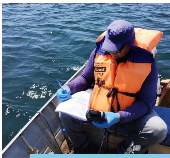
Utilização de sonda multiparâmetros para obtenção de dados físico-químicos, na estação amostral Q08, reservatório Serra do Livramento (Eixo Norte).
