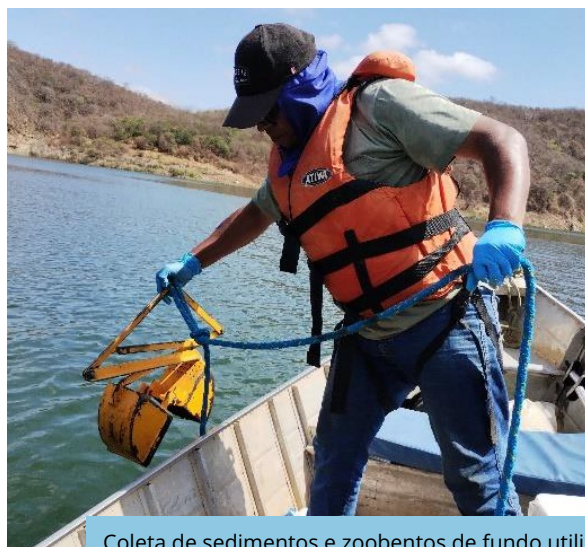
Coleta de sedimentos e zoobentos de fundo utilizando a draga de Petersen, na estação amostral Q13, Açude Atalho – Remanso (Eixo Norte).
