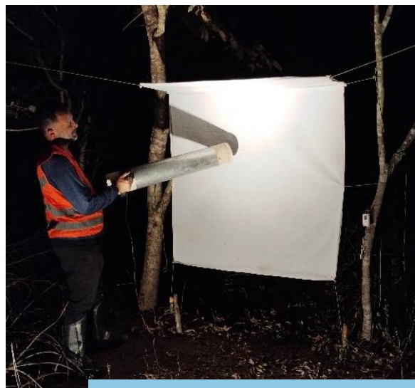
Coleta noturna de insetos adultos utilizando a armadilha Shannon adaptada, no reservatório Copiti (Eixo Leste).
