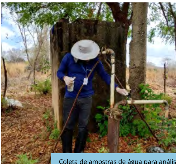
Coleta de amostras de água para análises de parâmetros físico-químicos e microbiológicos, no ponto amostral P25, município de São José de Piranhas/PB (Eixo Norte).
