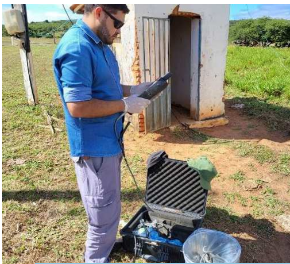
Obtenção de dados físico-químicos da água, utilizando a sonda multiparâmetros, ponto amostral P13, município de Brejo Santo – CE (Eixo Norte).
