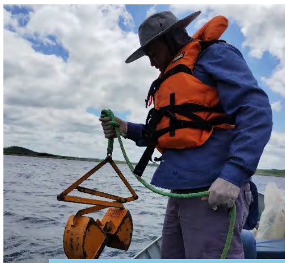
Coleta de sedimentos e zoobentos de fundo utilizando a draga de Petersen, na estação amostral Q65, Reservatório Campos – WBS 2114 (Eixo Leste).
