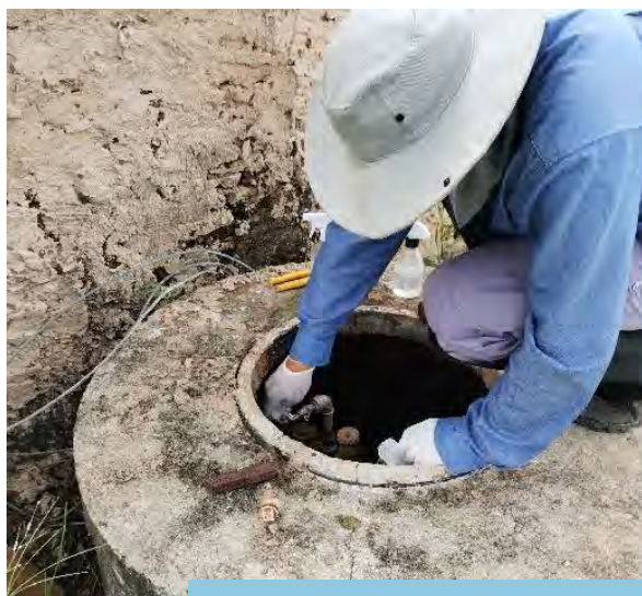
Realização de assepsia da torneira, utilizando hipoclorito de sódio, no ponto amostral P10, município de Brejo Santo/CE (Eixo Norte).
