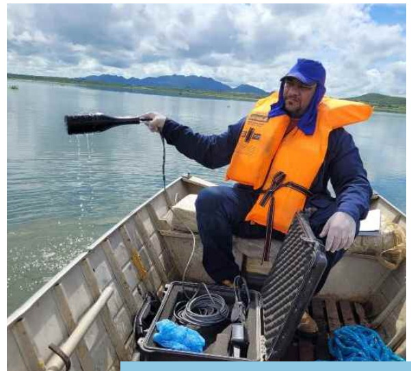
Utilização de sonda multiparâmetros para obtenção de dados físico-químicos, estação amostral Q24, Açude Orós (Eixo Norte).
