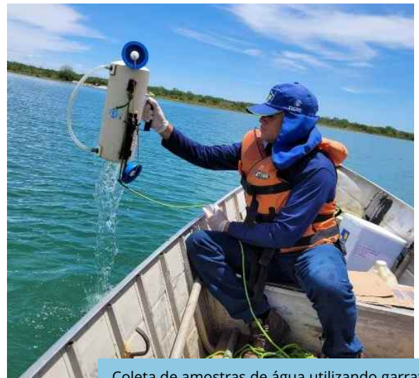
Coleta de amostras de água utilizando garrafa de Van Dorn, estação amostral Q61, Reservatório Bagres, (Eixo Leste).
