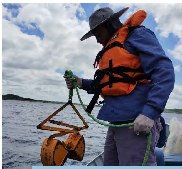
Coleta de sedimentos e zoobentos de fundo utilizando a draga de Petersen, na estação amostral Q65, Reservatório Campos – WBS 2114 (Eixo Leste).
