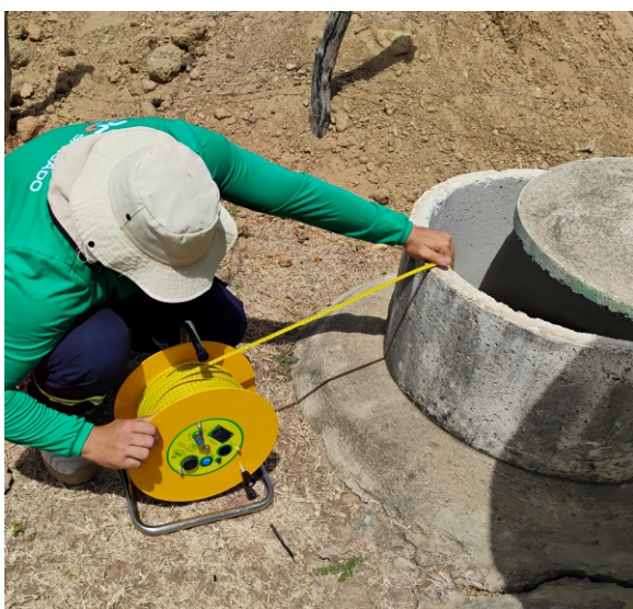
Medição do nível estático do poço no ponto de monitoramento PM04.
