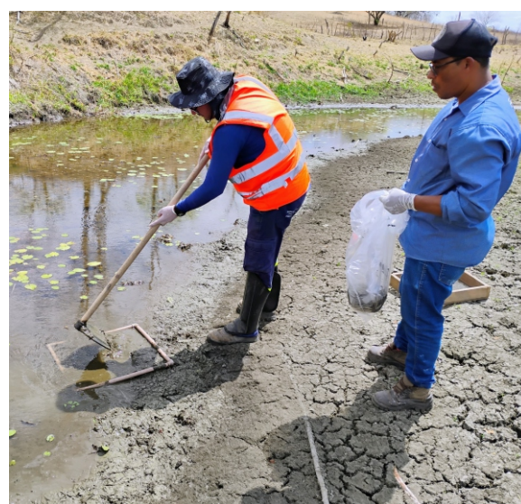
Coleta de sedimento para amostragem de zoobentos de margem, com quadrado e enxada no PM06.
