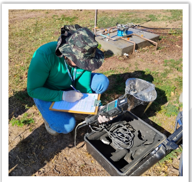
Utilização da sonda multiparâmetros para obtenção dos dados físico-químicos da água no ponto de monitoramento PM03.
