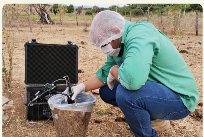
Utilização de sonda multiparâmetros para medição de parâmetros físico-químicos da água coletada no ponto de monitoramento Pm01.
