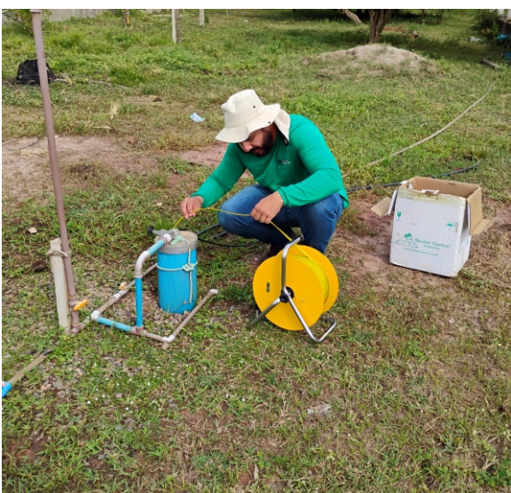
Medição do nível estático do poço no ponto de monitoramento PM-03.
