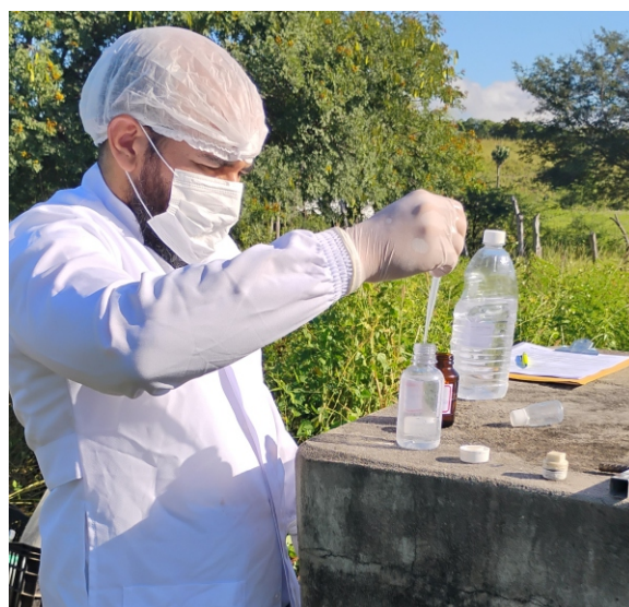
Preparação de amostra de água coletada no PM-01, com a aplicação de conservante, para envio ao laboratório de análise.
