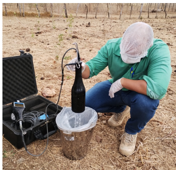
Utilização de sonda multiparâmetros para medição de parâmetros físico-químicos da água coletada no ponto de monitoramento Pm01.
