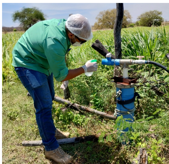
Assepsia do registro da encanação do poço, utilizando hipoclorito de sódio, para coleta de água no ponto de monitoramento Pm02.
