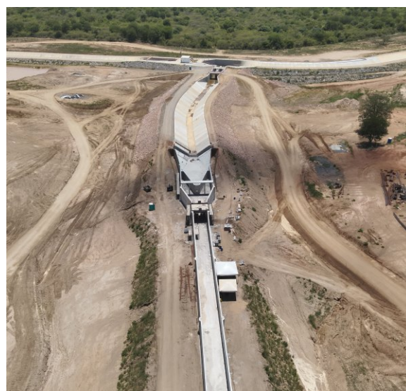
Utilização de Veículo Aéreo não Tripulado (VANT) para monitoramento dos locais susceptíveis ao surgimento de processos erosivos e carreamento de sedimentos no Segmento de Canal 01 e Rápido Fazenda Pau Branco.
