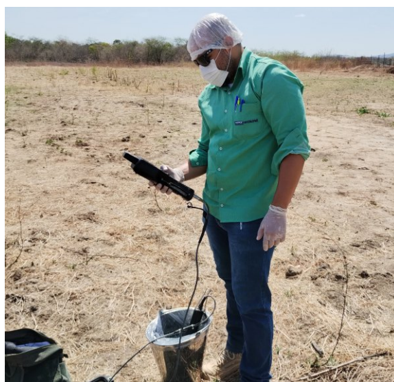
Utilização de sonda multiparâmetros para medição de parâmetros físico-químicos da água coletada no ponto de monitoramento PM-05.
