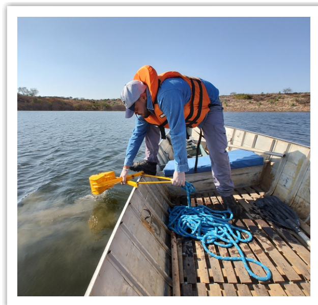
Coleta de Zoobentos de fundo com auxílio da draga de Petersen no Ponto PM05, Uiraúna/PB.
