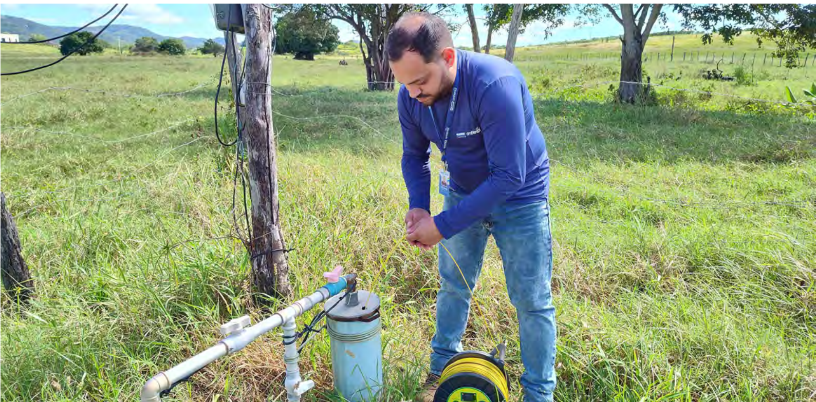
Mensuração do nível estático da água no Ponto de Monitoramento - PM03, município de José da Penha/RN.
