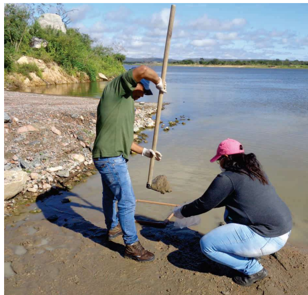
Coleta de zoobentos de margem com auxílio da enxada e do quadrado de PVC, no ponto de monitoramento I02. Arcoverde/PE.
