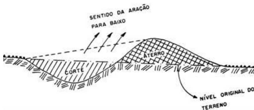
Figura 24.20. Terraço tipo Nichols construído com arado tombando somente de cima para baixo.
