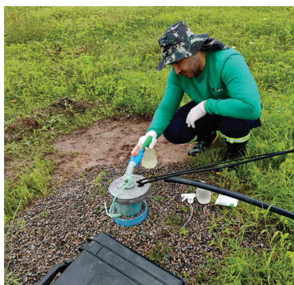
Assepsia da saída de água do poço para coleta de amostras de água no PM-05.
