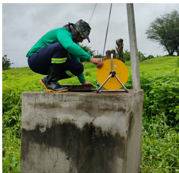
Aferição do nível estático no ponto de monitoramento PM-01.
