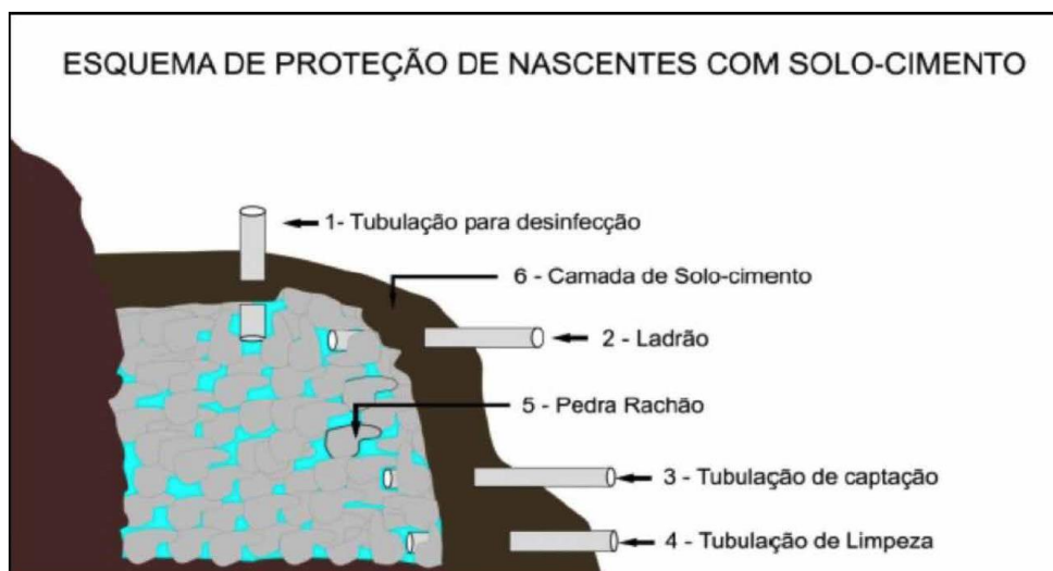
Figura 6. Esquema de proteção de Nascentes com Solo-Cimento
