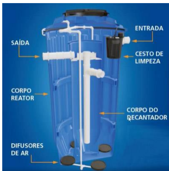
Figura 1: Detalhamento do sistema de tratamento de efluente unifamiliar
