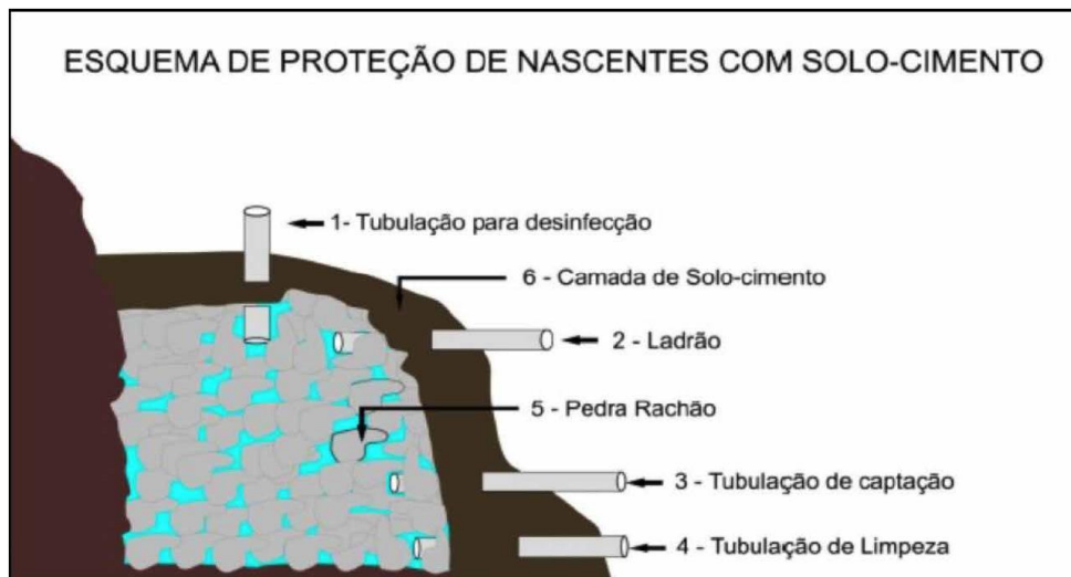
Figura 6. Esquema de proteção de Nascentes com Solo-Cimento
