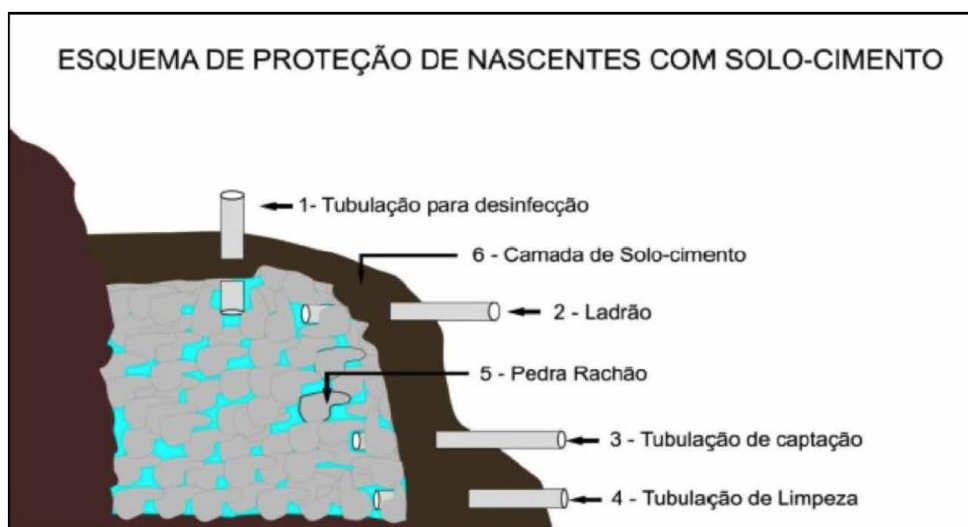
Figura 6. Esquema de proteção de Nascentes com Solo-Cimento
