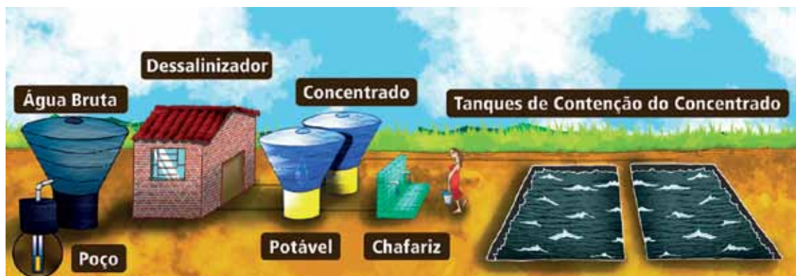
Figura 7 Representação esquemática do sistema de dessalinização adotado pelo Programa
