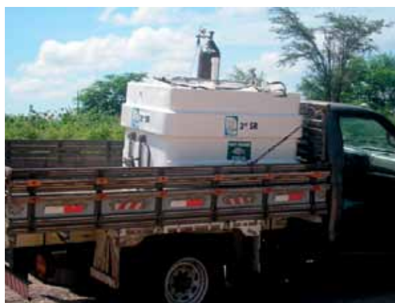
Foto 47: Caixa de transporte de peixes. Características: isolamento térmico; acoplada ao cilindro de oxigênio e capacidade de 400 a 2000L
