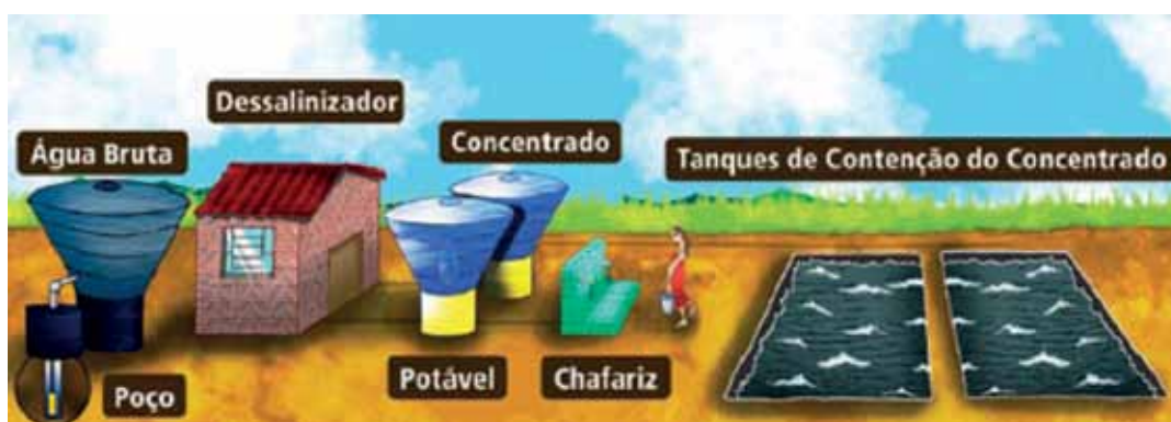
Figura 26 Sistema de dessalinização adotado pelo Programa Água Doce
