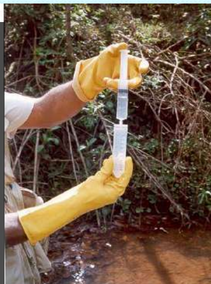
Filtragem de amostras para análise de cátions (com preservação em ácido) e ânions (sem acidificação)
