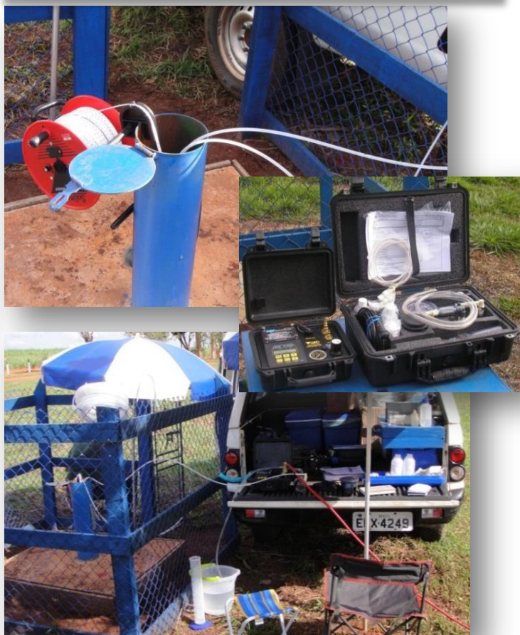
Equipamento para bombeamento em baixa vazão (low-flow).
