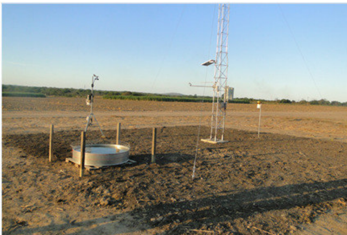
Estação agro meteorológica de usuário empresarial (Terracal) para monitoramento da irrigação.
