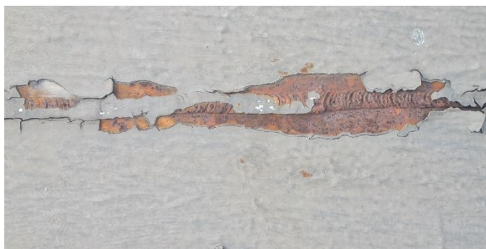
Imagem 6: Detalhe de solda executada em processo de corrosão.
