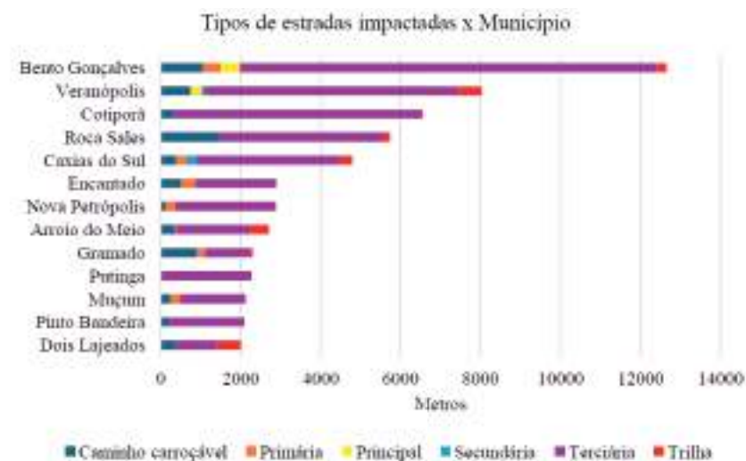
Figura 19. Categorias de estradas impactadas nos municípios mais atingidos
