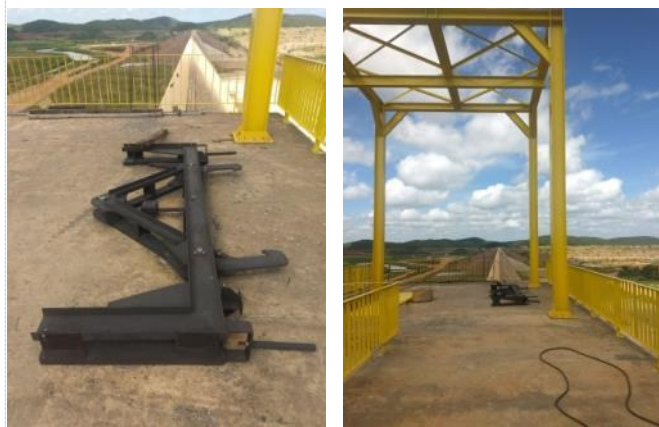
Figura 10-11 - Barragem Porcos – Viga pesadora da TUD
