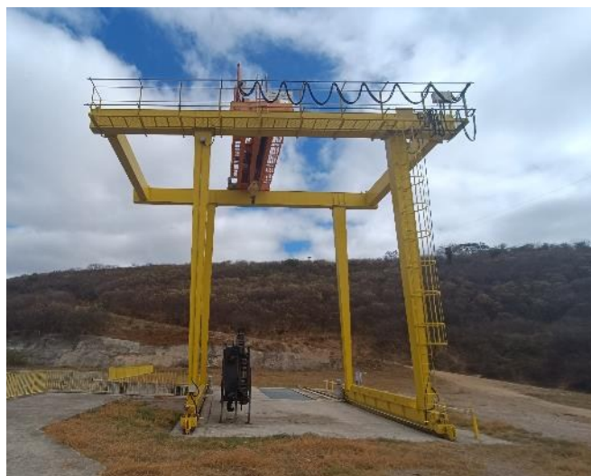
Figura 9-24 - Barragem Atalho – Pórtico da tomada de água
