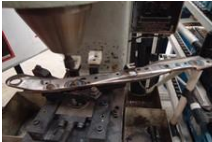
Preparação da rebitagem orbital da Lateral + Articulação
