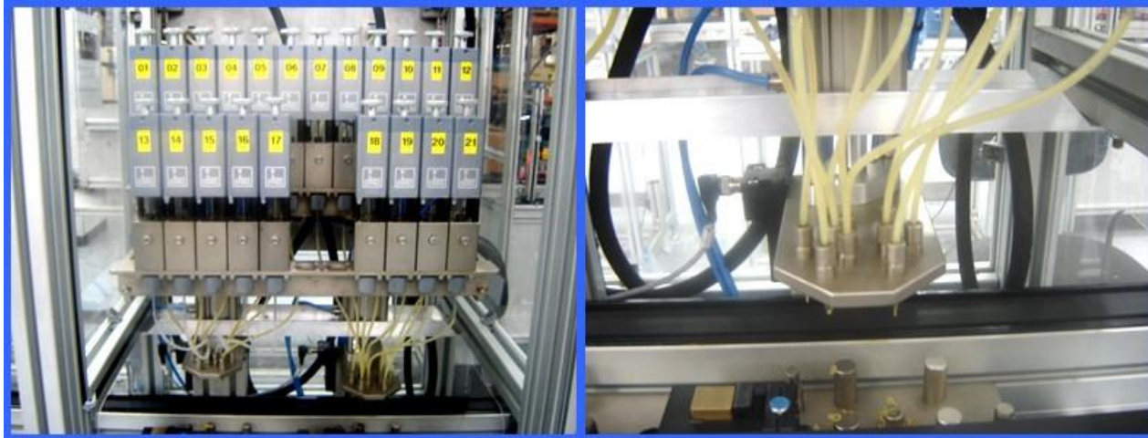
Linha Automática – Posto de Aplicação de Graxa nas Placas
