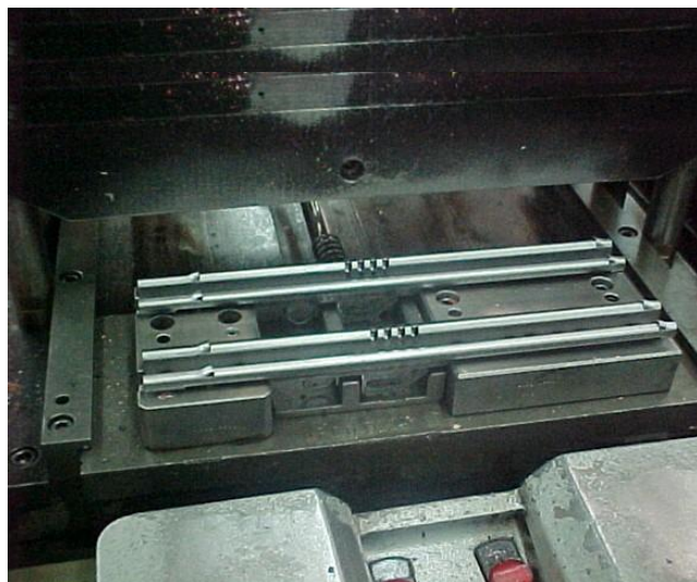
Dispositivo para Cravar 4 Parafusos (2 trilhos)
