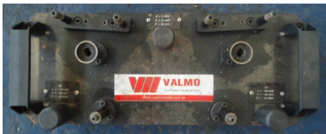
Dispositivo para Verificar a posição (Manual)
