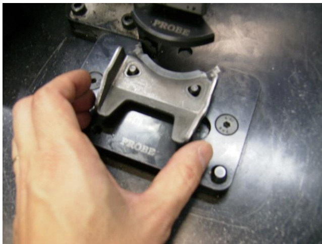
Dispositivo de Montagem Gleiter (Manual)
