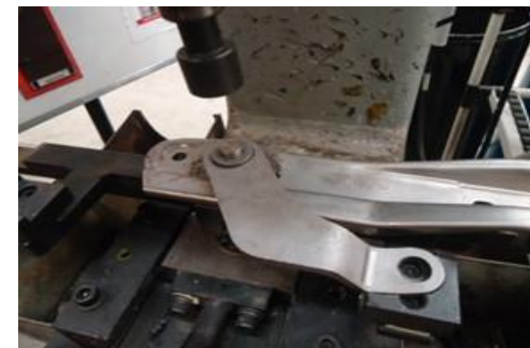
Processo a ser realizado: Rebitagem da Lateral + Articulação
