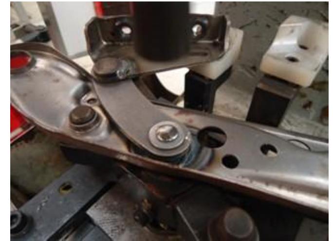
Processo realizado: Rebitagem da Lateral + Articulação
