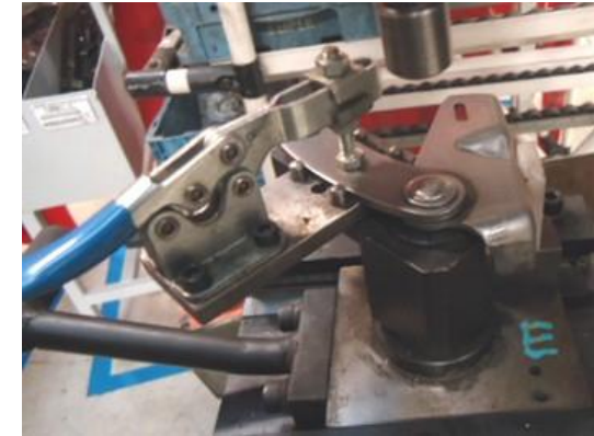
Rebitagem Suporte de Fixação + Articulação + Rebite
