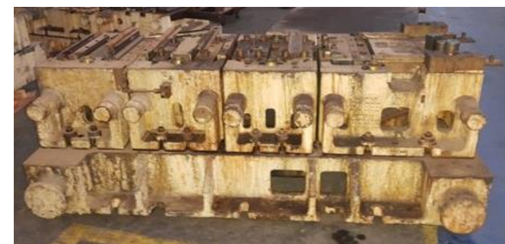
Ferramenta Progressiva 1 - Parte Inferior
