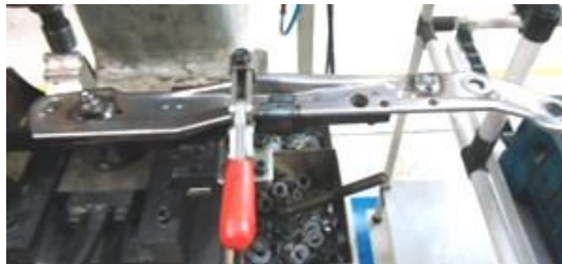
Preparação da rebitagem orbital da Lateral + Articulação
