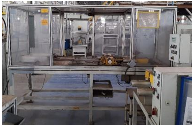
OP. 20 - Processo Engraxar + Montar Trilhos com Suportes de Esfera
