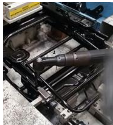
Processo realizado: Parfusamento do Trilho na Lateral do Assento, com auxilio da parafusadeira Tensor
