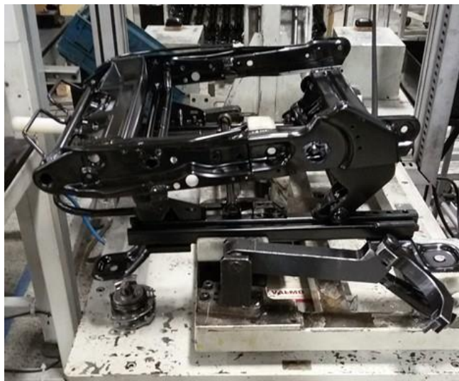
Dispositivo de Montagem do Mecanismo Regulador de Altura
