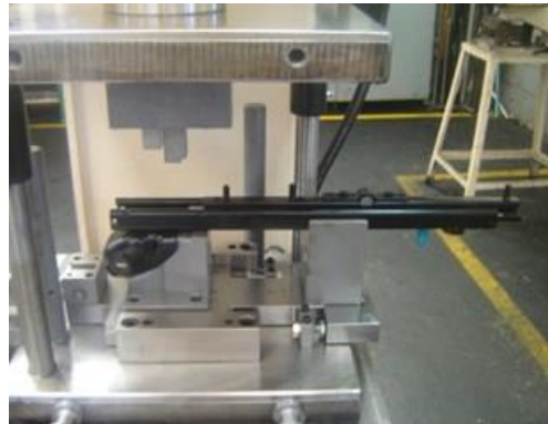
OP. 60 - Processo Rebitar Adaptador Traseiro (interno)
