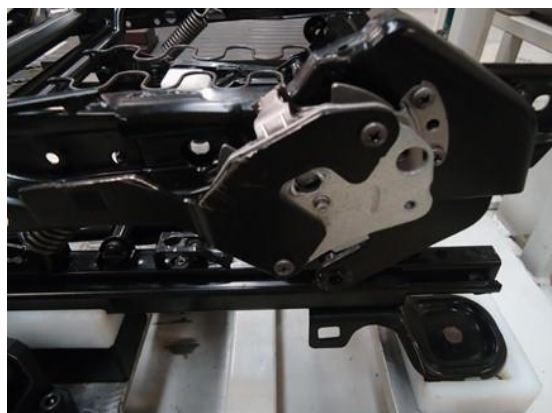
Dispositivo de Montagem do Mecanismo Regulador de Altura
