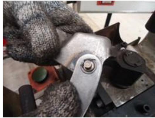
Montagem Suporte de Fixação + Articulação + Rebite
