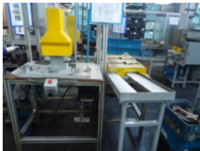
Dispositivo para Montar a Placa Trava no Trilho Superior
