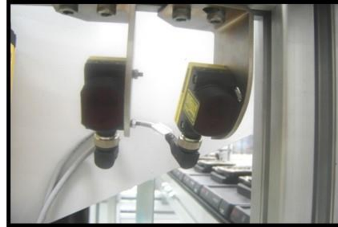
Sensores para verificar presença do mancal e prato protetor
