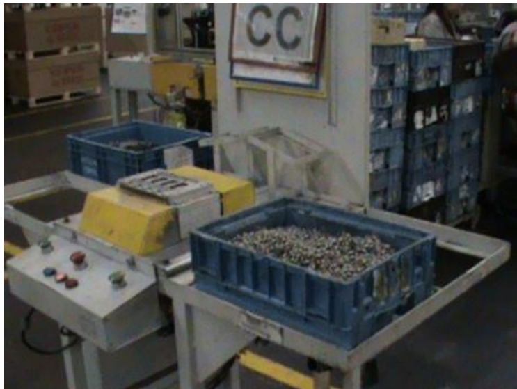
OP. 20 - Processo Montar Molas na Placa Trava
