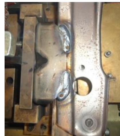
Processo realizado: Soldar Suporte Traseiro na Lateral do assento
