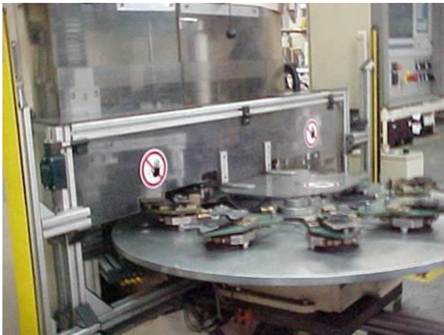
Máquina de Soldar Projeção (Glamatronic)
