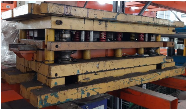
Ferramenta Progressiva Chapa Reforço
